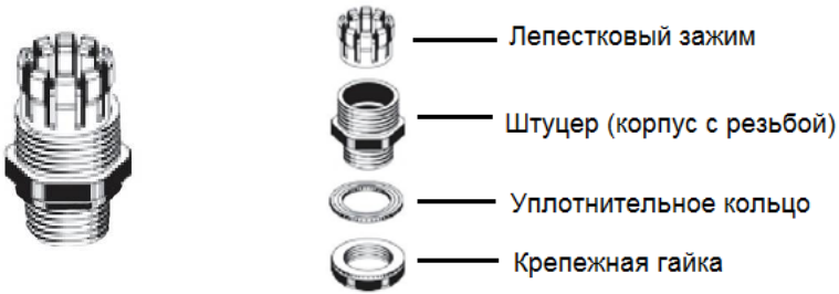
Рис.2 Устройство гермовводов
